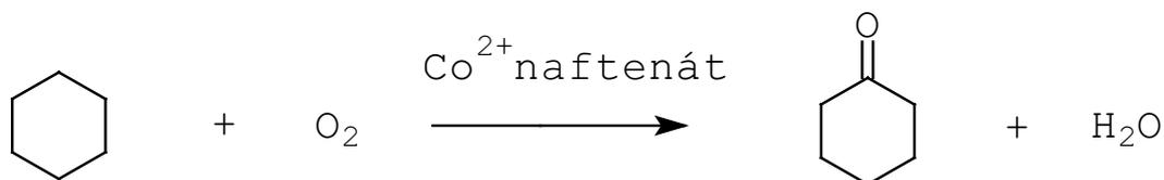
Jedná se o exotermní radikálovou řetězovou oxidaci, která se uskutečňuje v **kaskádě tří průtokových míchaných reaktorů**, kde vznikající teplo se odvádí varem reakční směsi (vazba mezi tlakem a teplotou varu), maximální selektivita je při 155°C a tlaku 8 - 9 B. Řada následných konverzí si žádá, aby konverze C<sub>6</sub>H<sub>6</sub> nebyla úplná.
