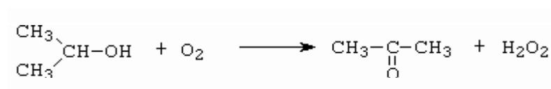
**Obrázek 5.25** Výroba peroxidu vodíku pomocí 2-propanolu
